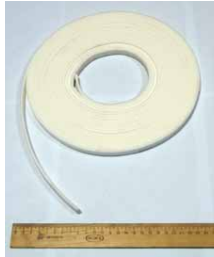
Рис. 24 УПСГ 4х10 мм (уплотнитель сэндвич – профилей горизонтальный (полиуретан), Россия
