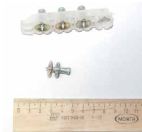
Рис. 28 Гвоздь X-ENP-19 L15 HILTI для монтажного пистолета, Германия
