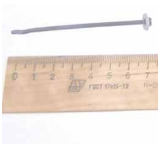
Рис. 29 Пружинный анкер "Spike" DT-4.8x76 с шайбой уплотнительной с ЭПДМ - прокладкой Ø14, производство SFS Швейцария
