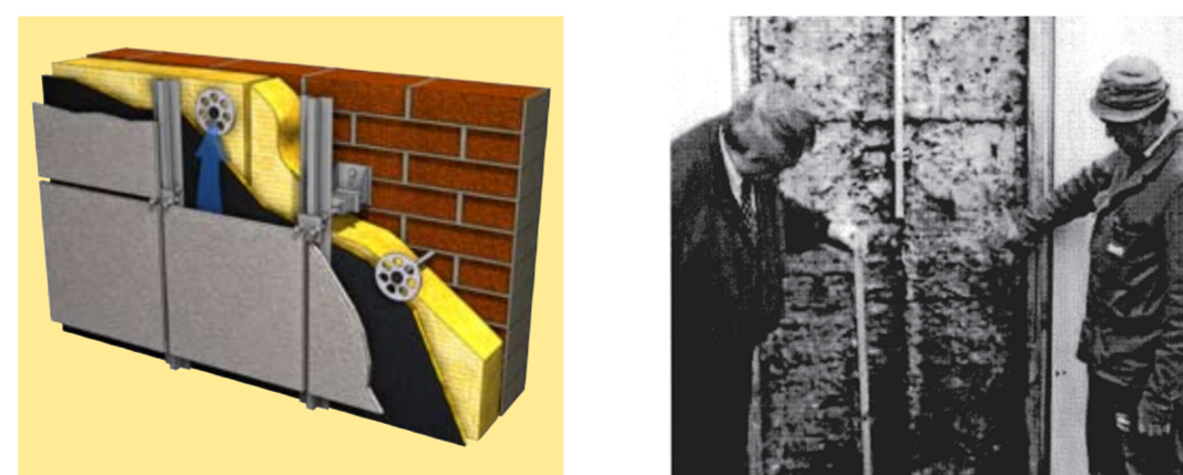
Схема конструкции системы навесного вентилируемого фасада
